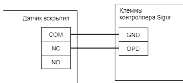
Подключение датчика вскрытия корпуса к контроллеру.
