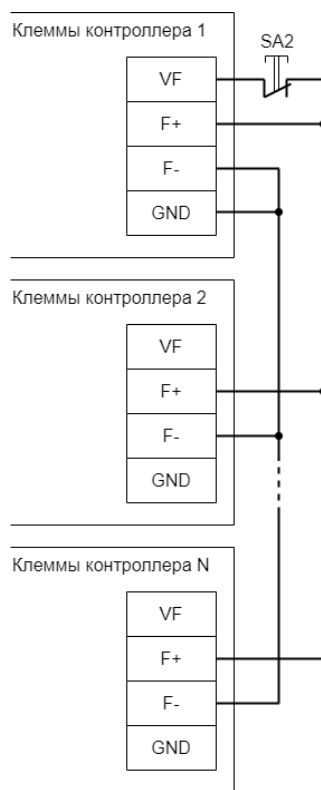
Подключение кнопки разблокирования к нескольким контроллерам.
